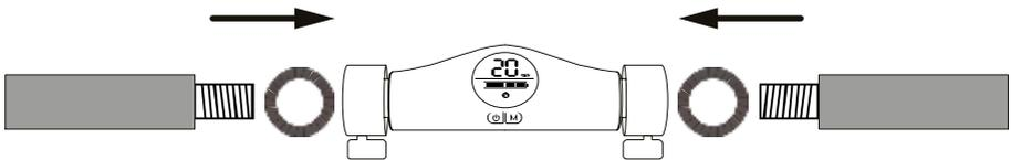
Durch Drehen zum Fahrer hin werden die Griffe eingedreht und durch festes Anziehen gegen unabsichtliches öffnen gesichert:
