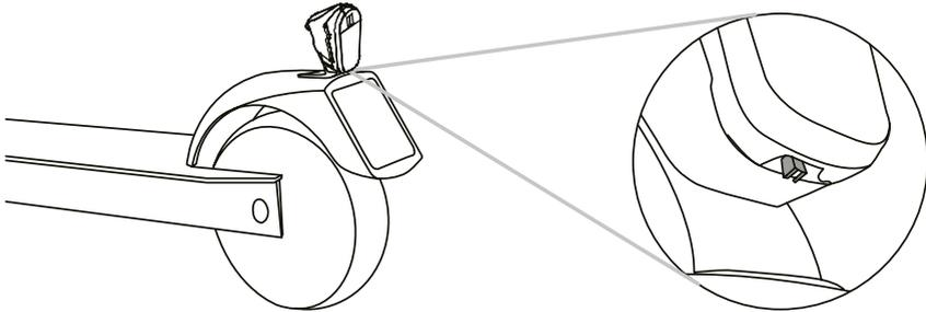
Die Batterie vom **LED-Rücklicht 25** sind mit einer Sicherungsglasche vor Entladung geschützt. Vor der Inbetriebnahme ist diese zu entfernen:
