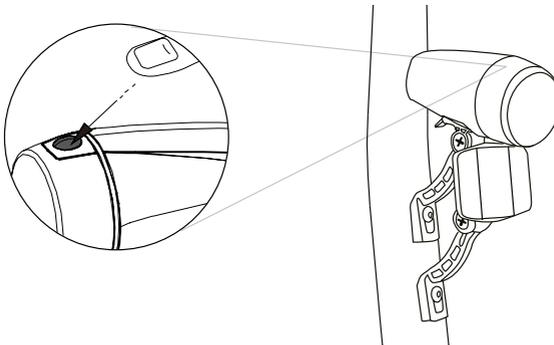
Die Batterien vom **LED-Frontlicht 2** sind mit einer Sicherungsglasche vor Entladung geschützt. Vor der Inbetriebnahme ist diese zu entfernen:
