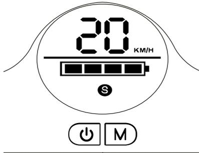
3. Der eScooter muss leicht angerollt werden. Werden 6 km/h auf der **Geschwindigkeitsanzeige** 31 angezeigt, kann durch Drücken des **Beschleunigers** 15 die Geschwindigkeit erhöht werden. Den **Beschleuniger** 15 etwas loslassen, um die Geschwindigkeit zu verlangsamen.
